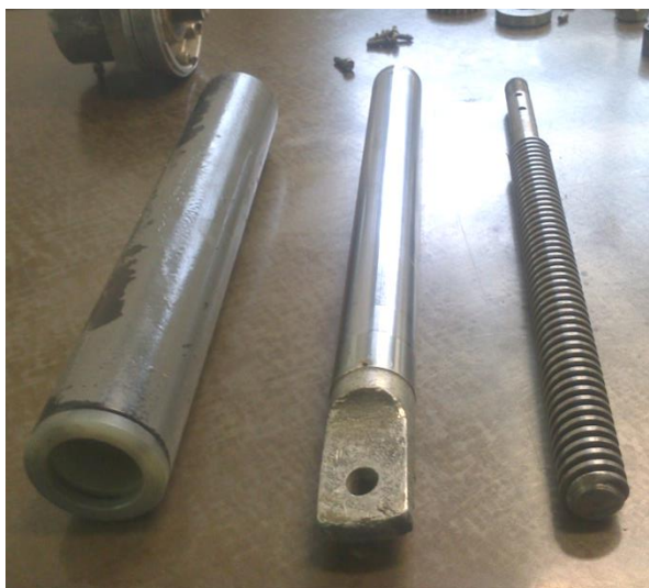
Figura 3.7 – Mecanismo de portão desmontado. Tem-se, da esquerda pra direita, luva telescópica, luva roscada deslizante e eixo.
