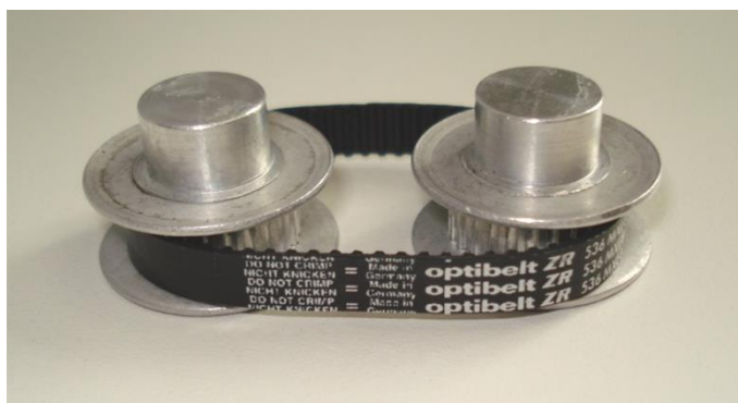
Figura 3.15 - Fotos das polias e correia sincronizadoras do encoder do eixo de elevação.
