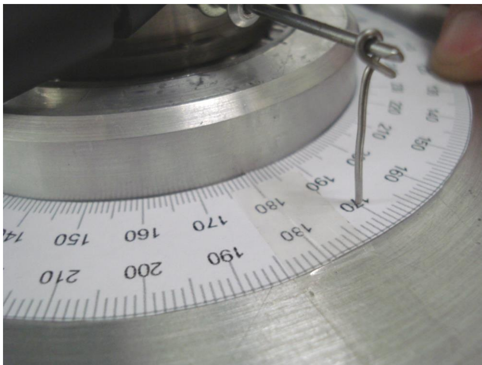
Figura 5.5 - Posição 3 do teste de repetibilidade do eixo azimutal.
